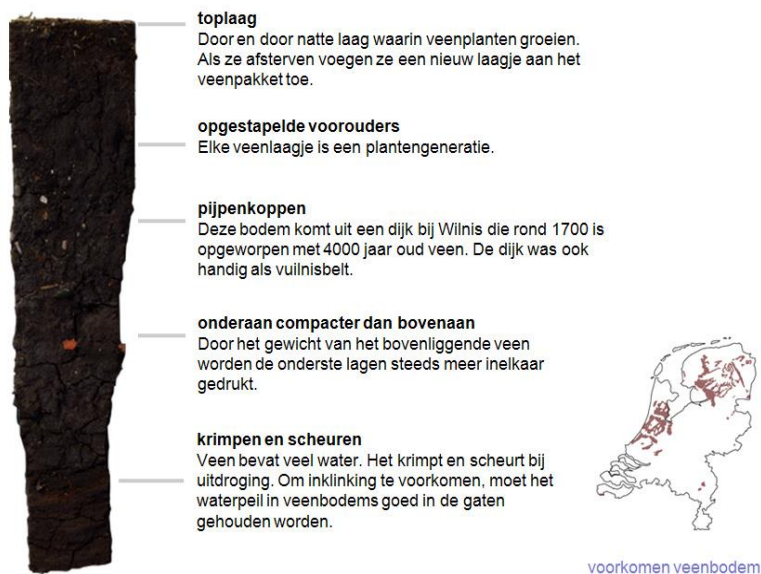
Figuur 1: Opbouw van een veenbodem
